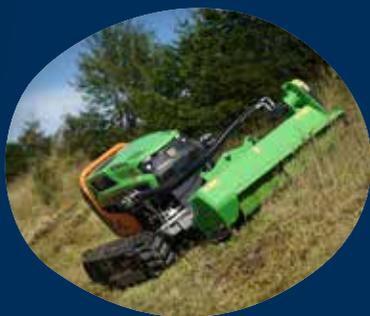
Fahrwerksverstellung über Rundprofilrohre
