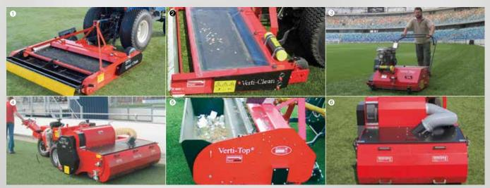
● Speed-Clean für Kunstrasen. Das Granulat wird aufgenommen, gesiebt, wieder abgelegt und nivelliert. ● Verti-Clean Kunstrasenreiniger, Kehrbürste zur Schmutzaufnahme, vibrierende Siebplatte, Arbeitsbreite 150 cm. ● Selbstfahrendes Verti Top mit eigenem Motor. Reinigung des Materials durch Siebein-
