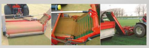
Der **Eliminator** nimmt das Füllmaterial vom Kunstrasen mit einer rotierenden Bürste auf. Ein Förderband transportiert das herausgearbeitete Material auf einen Anhänger. Arbeitsbreite 150 cm. Das regenerierte Substrat wird wieder ausgebracht.
