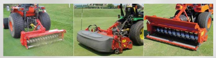
Der neue **RotaDairon Vertikalschneider** ist für den Einsatz auf Golfrasen, Greens- und Sportrasenflächen entwickelt worden. Vertikutierfeineinstellung 0 – 5 mm. Tiefenvertikalschneiden bis 60 mm, drei verschiedene Messer anbaubar. Messerantrieb
