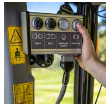
Das PotiPro-Steuerungssystem ermöglicht Änderungen der Streubreite und -menge während der Fahrt.
