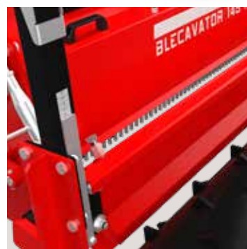
Nivellierbalken für eine glatte und ebene Oberfläche.
