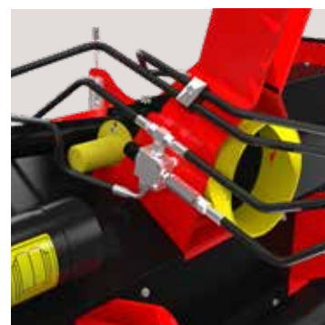
Einstellbare Bandgeschwindigkeit zur Kontrolle des Materialflusses.
