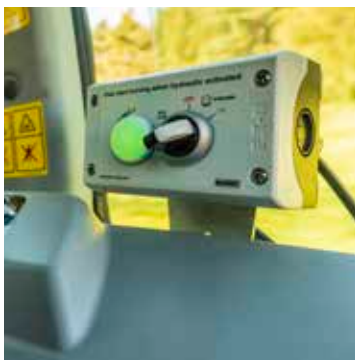
Analogen Steuerungssystem ermöglicht das Ein- und Ausschalten vom Schleppersitz.
