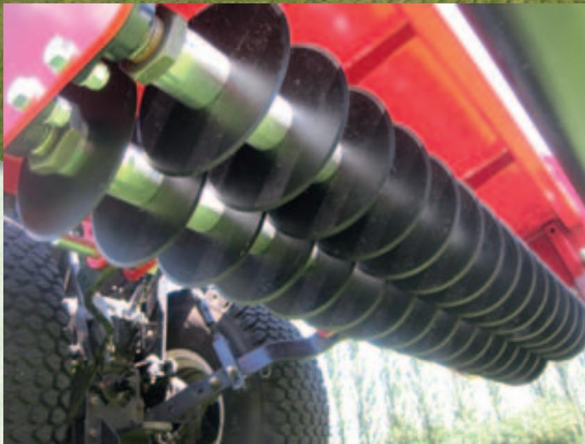
Die doppelte Scheibenwelle ist für die intensive Oberflächenbelüftung vorgesehen.
