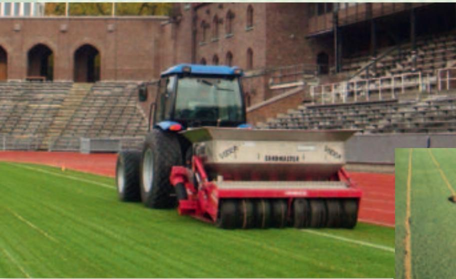
Der Vibra-Sandmaster lockert und entwässert die Bodenoberfläche effektiv in einem Arbeitsgang. Vor den Vibra-Sandmaster wird das Verti-Quake montiert, das den Boden auflockert und bis zu einer Tiefe von 25cm aufschlitzt. Vibrierende Messer verbreitern die Schlitz und injizieren Sand in eine Tiefe von 15 bis 20cm. Die nachlaufenden Räder drücken den Boden wieder an und sorgen somit für eine gut bespielbare Rasenfläche. Der Vibra-Sandmaster arbeitet mit feuchtem oder
