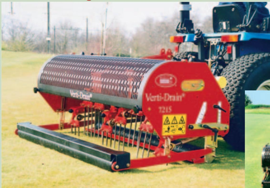
Das kompakte Verti-Drain 7215 kann an Traktoren mit 25PS angebaut werden.
