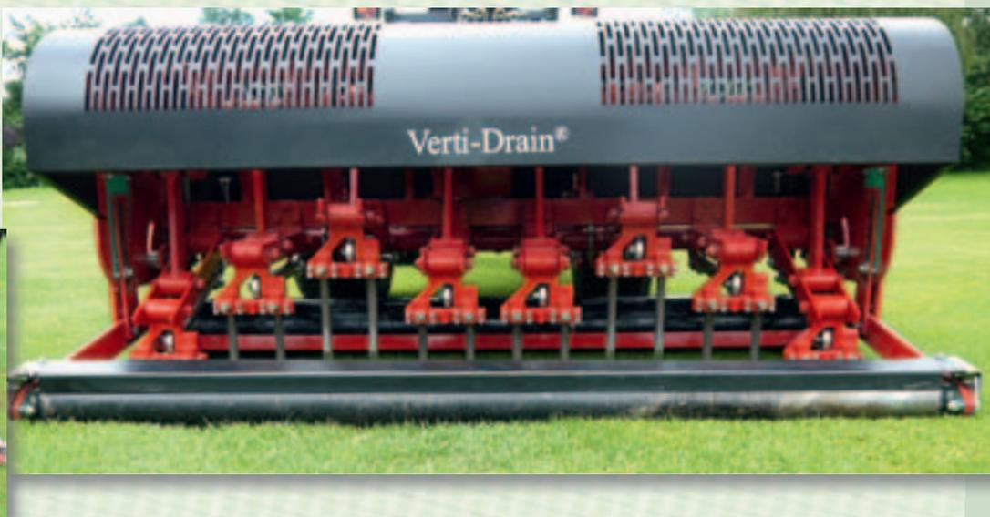
Die robuste Verti-Drain-Baureihe ist für die Bodenbearbeitung mit einer Arbeitstiefe von 400mm vorgesehen. In dieser Baureihe stehen vier verschiedene Modelle mit 3-Gang-Getriebe zur Verfügung, die an jeden Traktor angeschlossen werden können.
