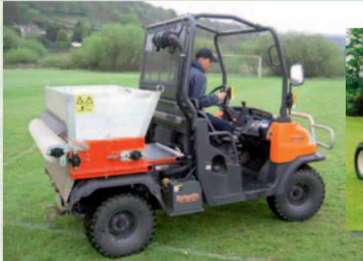
*Kubota RTV mit dem speziell gebauten Rink 1003 mit einem Volumen von 0,4m<sup>3</sup>.*
