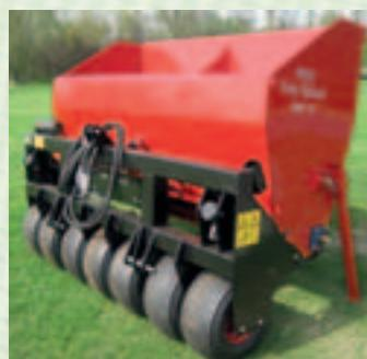
Die Baureihe Easy-Spread TR ist für die Ein-Mann-Bedienung konzipiert. Der grosse Behälter kann hydraulisch angehoben und gesenkt werden. Das gesamte Gewicht wird über die grosse Bereifung auf die Laufachse verteilt.
