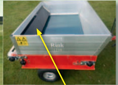
Das Staublech wird bei feuergetrockneten Sand verwendet.
