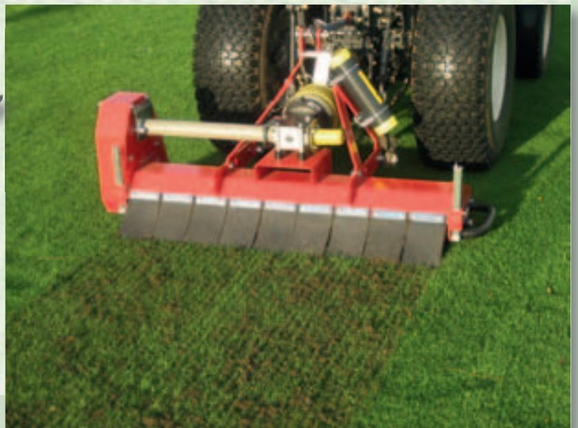
Zur Verteilung von Material oder zum Bürsten des Rasens sind unterschiedliche Bürsten erhältlich.
