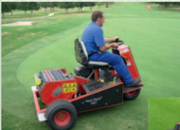
Das Aufsitzmodell der Verti-Drain 7007 Hydro wird hydrostatisch angetrieben. Die Geschwindigkeit lässt sich mit einem Fußpedal leicht regeln. Diese dreirädrige Maschine ist überaus wendig und hat eine Höchstgeschwindigkeit von 5km/St.
