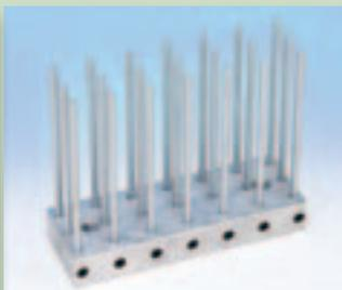
Die Zinken lassen sich schnell mit einem Hebel für die Tiefenlockerung schräg und für das klassische Aerifizieren in die vertikale Position umstellen.
