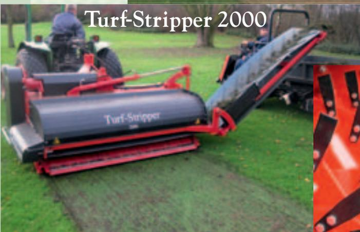
Der Turf-Stripper kann mit Fräsmessern (oben) oder Vertikutiermessern (unten) ausgestattet werden.
