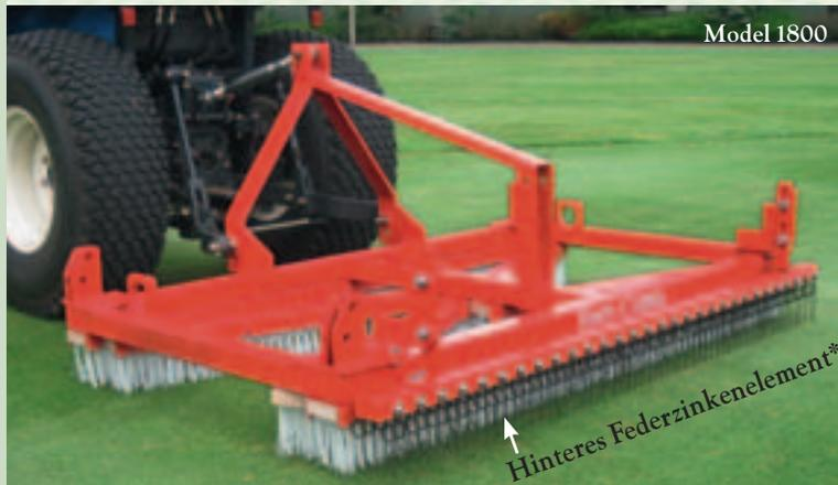
Das Verti-Comb ist zum schnellen und effizienten Bürsten und Auflockern großer Rasenflächen gedacht. Das Verti-Comb 1800 kann mit einklappbaren Seitenflügeln in das Modell 4000 umgerüstet werden (4,0m Arbeitsbreite).
