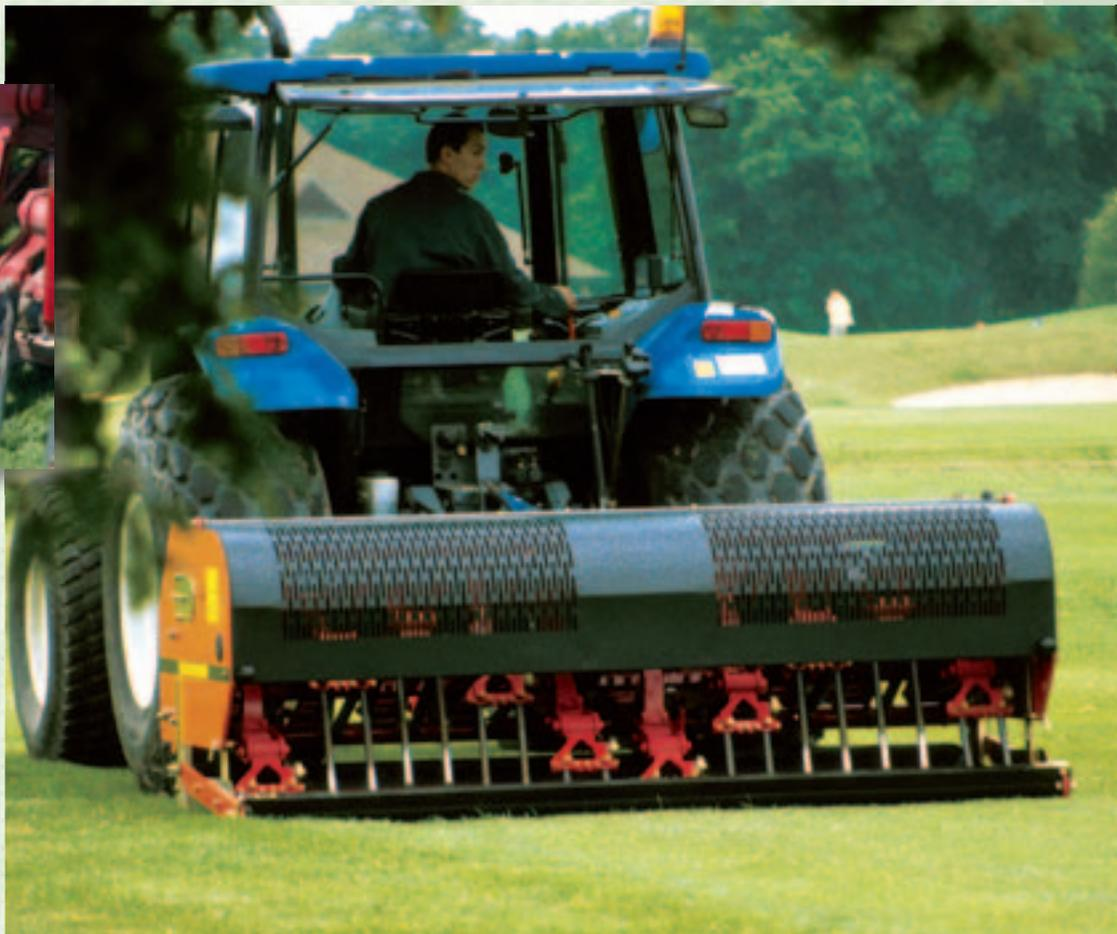
Die robusten Geräte der 76-er Baureihe haben ein höheres Gewicht als die 75-er Baureihe, sind mit einem leistungsstärkeren Getriebe ausgestattet und verfügen über eine Zapfwelle und Heckstützrollen, die für besonders harte Böden ideal sind.
