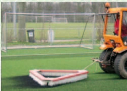
Zum Bürsten und Auskämmen des Rasens ist das bewährte Verti-Broom unschlagbar (Modelle 185 und 240). Die hochwirksame Dreiecksanordnung der Bürsten glättet und bürstet jeden Grashalm. Die weichen, verschleißfesten Bürsten sorgen für schnelles und effizientes Einbürsten des Sandes und für eine glatte Oberfläche.
