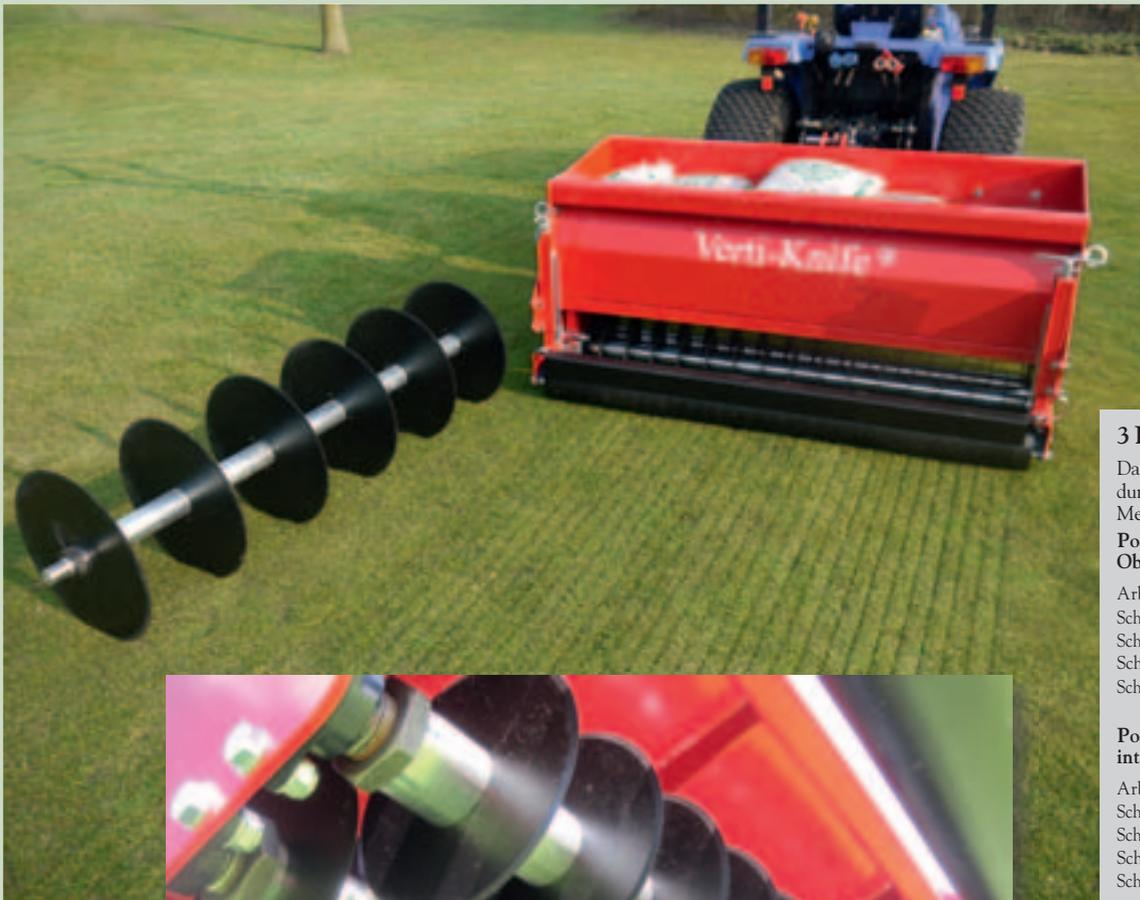
Beim Verti-Knife schlitzten Messerscheiben in verschiedenen Durchmessern und Konfigurationen den Boden bis zu einer Tiefe von 150mm auf. Dadurch können Luft, Wasser und Nährstoffe wieder besser in den kritischen Wurzelbereich vordringen. Das fördert die Wurzelichte und -tiefe.
