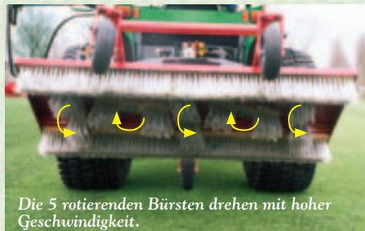
Die 5 rotierenden Bürsten drehen mit hoher Geschwindigkeit.
