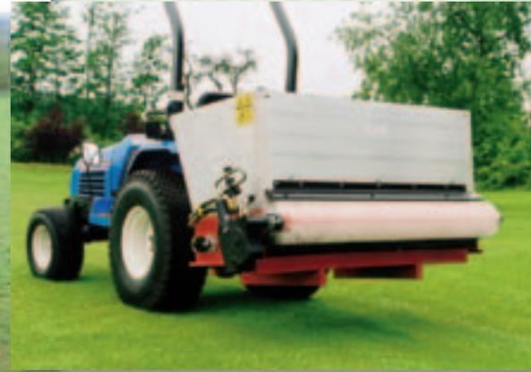
*Der Rink 1005 wird in die Dreipunkt Schlepper angebaut und hat ein Volumen von 0,75m<sup>3</sup>.*
