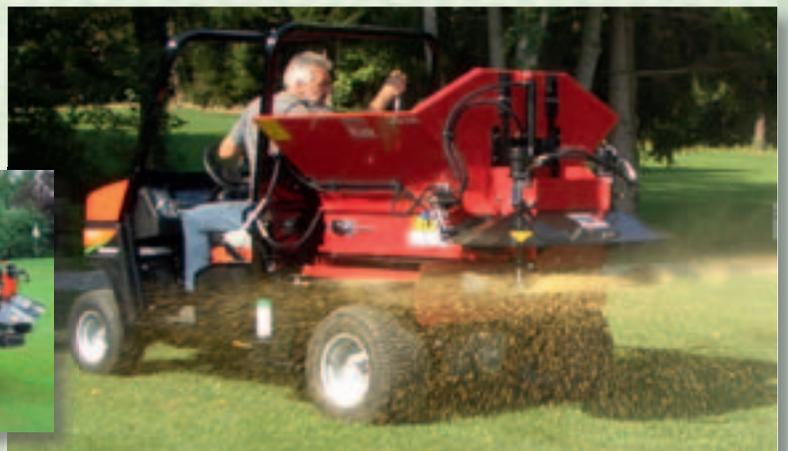
Das Speed-Seed verteilt den Grassamen mittels Nadelwalzen in Tausende kleiner Löcher.
