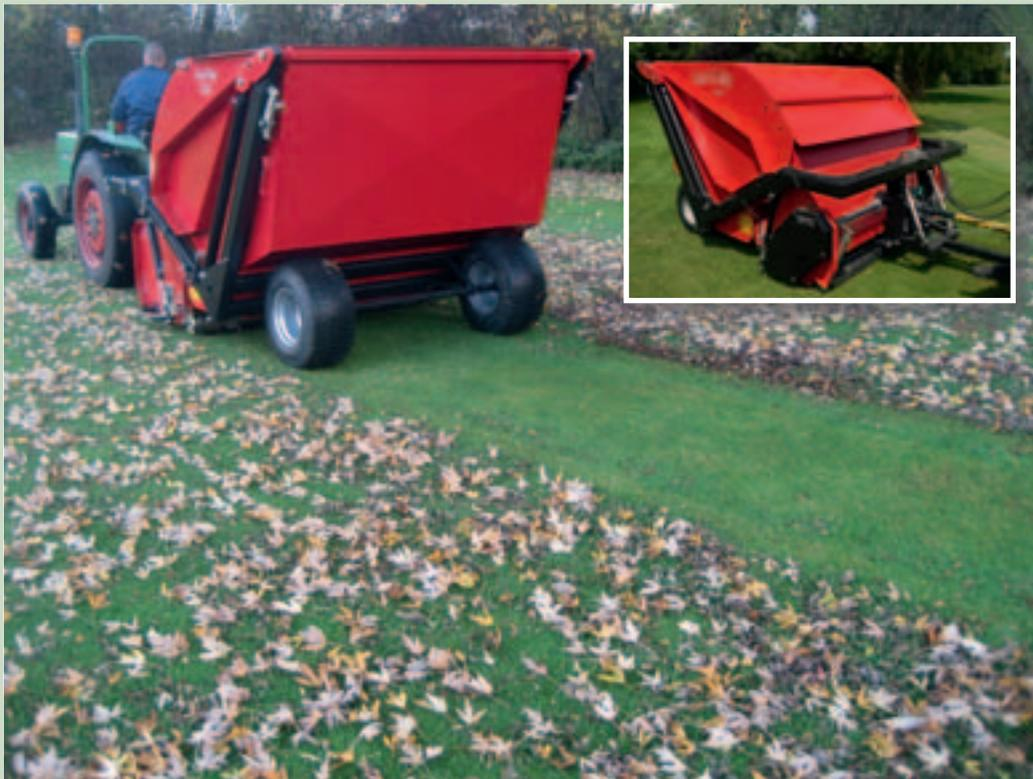
Das Turf-Tidy-Modell 3000 hat den zusätzlichen Vorteil eines frei schwebenden Kopfes, der den Konturen des Bodens folgt und dadurch für eine hohe Genauigkeit des Schnittes und der Aufnahme sorgt.
