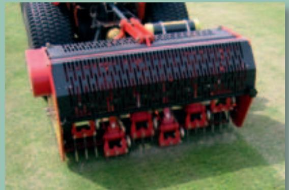
Nachdem der Sand auf der Rasenfläche verteilt wurde, arbeitet das Verti-Drain den Sand mittels Vollzinken in den Boden ein. Mit einem idealen Zinkenwinkel von 5 - 10 Grad und einem geringen Lochabstand arbeiten die Zinken den Sand in den Boden ein und verbessern dadurch die Bodenstruktur.
