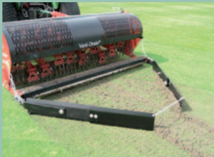
Der Schwadformer reiht die Erdkegel auf, sodass sie sich nachher mühelos einsammeln lassen.
