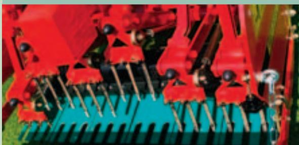
Der Rasenniederhalter gewährleistet, dass die Rasenfläche auch bei oberflächlicher Bewurzelung während des Vertikutierens oder der Tiefenlockerung nicht beschädigt wird.
