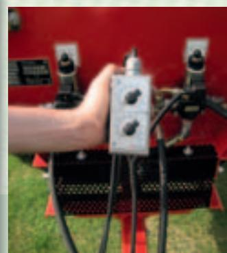
Eine elektrische Steuerung der Teller und des Förderbandes ermöglichen dem Bediener eine problemlose Arbeit vom Schlepper aus.
