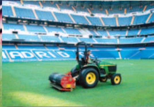
Das Verti-Drain 7113 hat ein 3-Gang-Getriebe und eine Arbeitsbreite von 1,3m.
