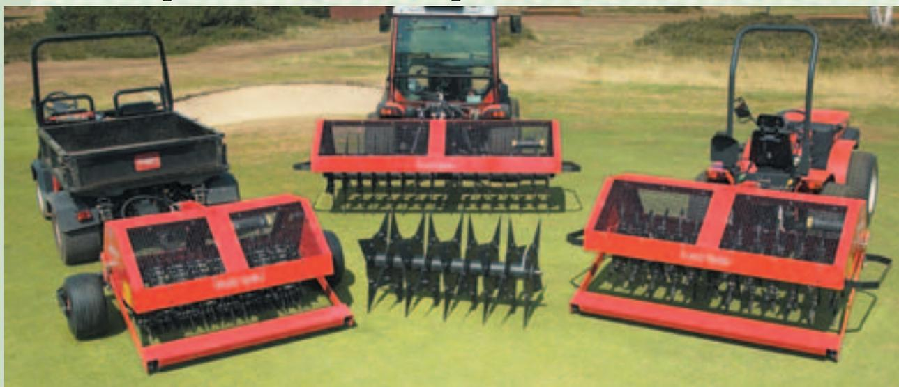
Multi-Spike und Level-Spike schlitzten den Boden mit verschiedenen, wählbaren Messergrößen auf. Durch Verriegelung der Nachlaufrolle wird die maximale Arbeitstiefe eingestellt.
