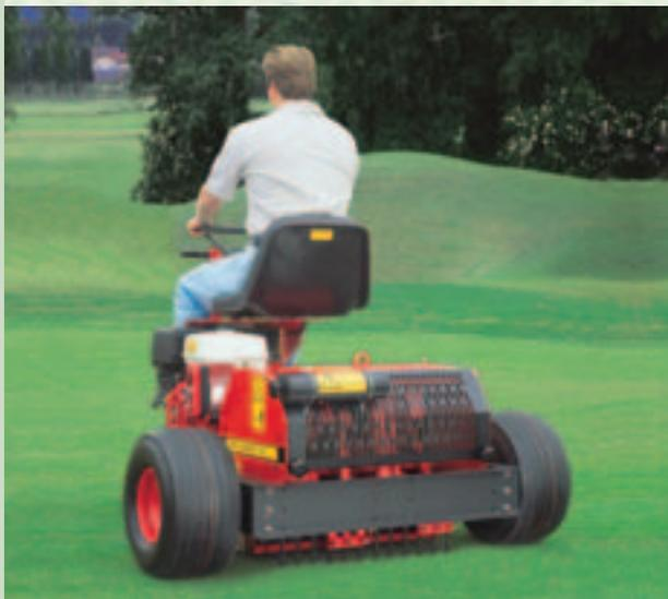
Das selbstfahrende Verti-Drain 7007 kann sowohl als Aufsitzgerät verwendet oder über einen Lenkholm rückwärts gehend handgeführt werden. Dieses sehr wendige Verti-Drain arbeitet schnell und mühelos auch in schwer zugänglichen Bereichen.
