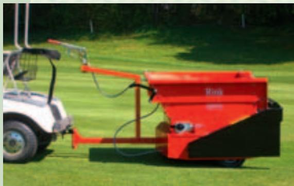
Der Rink TB950 ist ein radangetriebener Streuer und kann von nahezu jedem beliebigen Fahrzeug gezogen werden. Die Bürste und das Förderband werden über die Räder (wahlweise 2 oder 4-Radantrieb) angetrieben und sorgen für eine gleichmäßige Ausbringung.
