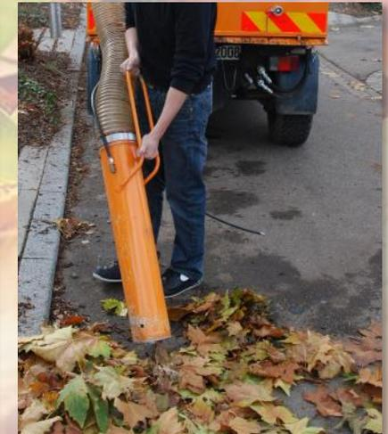
Flexible Absaugung mit optionalem Handsaugrohr
