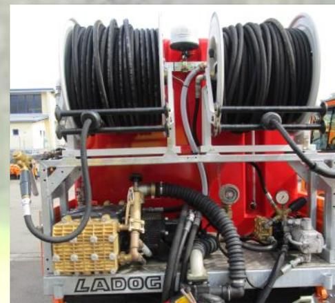
LADOG T-1250 Wasserpumpenaufbau
