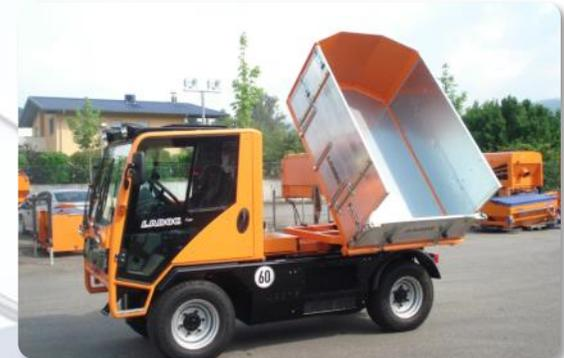
T-1250 mit drehbarer Kipperpritsche
