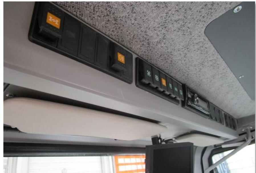
Diverse Funktionsschalter, Radio und Fahrtschreiber etc. sind übersichtlich und bequem erreichbar in der Dachkonsole untergebracht
