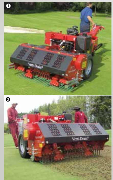
① Carrier auf dem Golfplatz mit Vollmeißel ② Carrier auf Sportanlagen mit Hohlspoons
