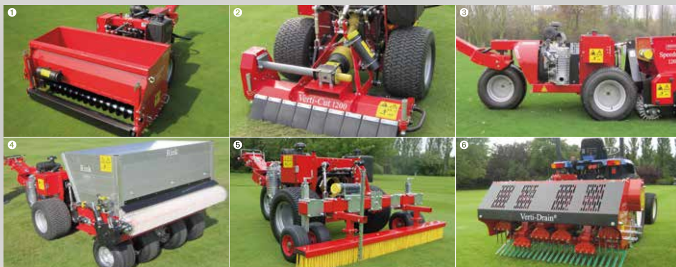
① Scheiben-Schlitzmessersystem – Verti-Knife ② Vertikutier-Anbaugerät mit Feinschlitzmesser ③ Rasennachsaatgerät Speed Seed - Konische Spikes ④ Anbausandstreuer mit Streuwalze ⑤ Bürste für die Sandverteilung, -verfüllung ⑥ Verti-Drain VD1513 angebaut an einen Kleintraktor
