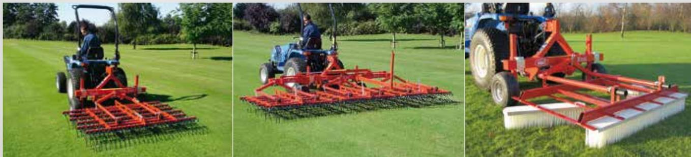
Die Zinken des Verti-Rake striegeln durch den Rasen und lockern den Filz. Die Zinken befinden sich in einer speziellen Vorrichtung, die den Verlust der Zinken während des Betriebs verhindert. Durch die Bearbeitung können Sauerstoff und
