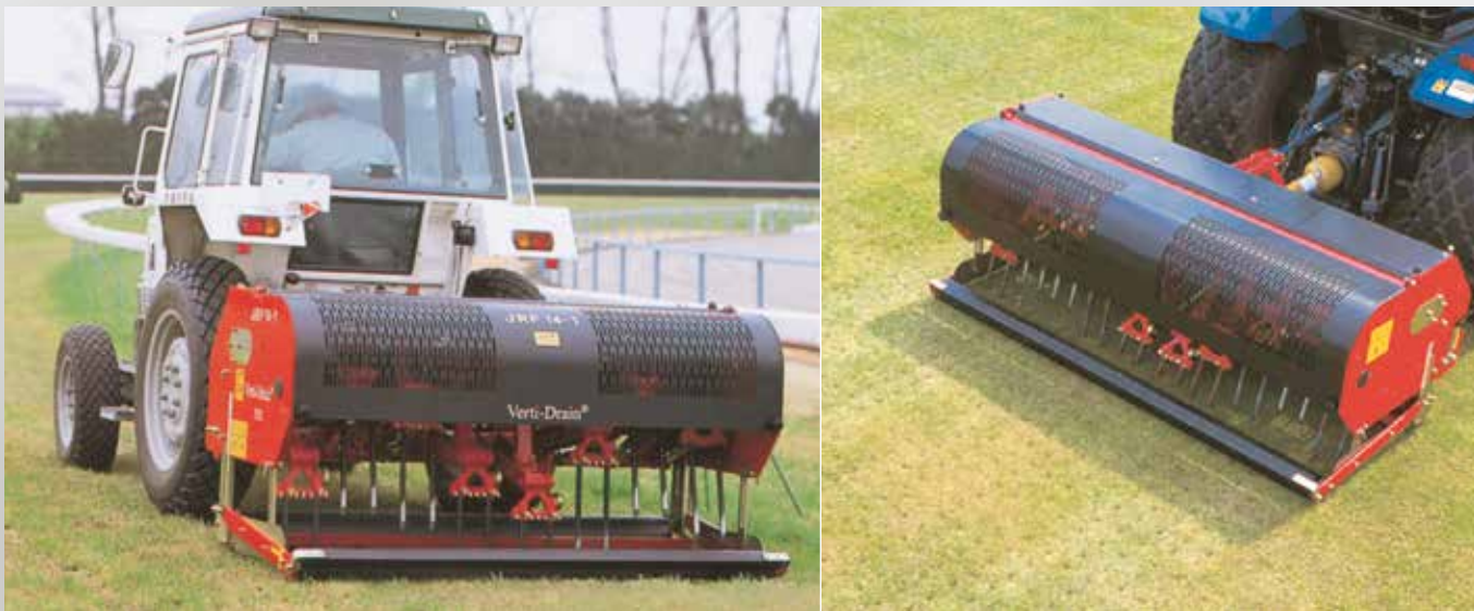
Das Modell VD7521 mit einer Arbeitsbreite von 210 cm wird von Garten-, Landschafts- und Sportplatzbaufirmen verwendet.
